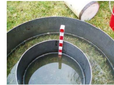
**Bild 9: Doppelring-Infiltrometer in der Messphase (mit Meterstab zur Bestimmung der Infiltrationsmenge)**
