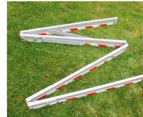
**Bild 13: Klappbare 4-m-Richtlatte**
