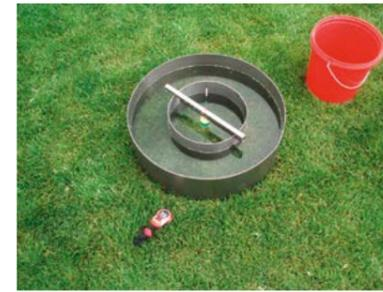
**Bild 8: Doppelring-Infiltrometer in der Sättigungsphase (mit Schwimmer zur Bestimmung der Infiltrationsmenge)**
