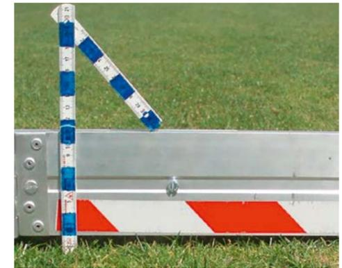
**Bild 14: Messen einer Bodenabsenkung mit Meterstab**
